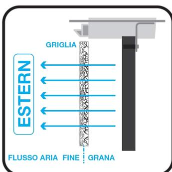
Estrarre i 2 portafiltro dalla parte posteriore della macchina. Montare un **nuovo filtro** in ciascuno telaio nero. Parte ruvida della griglia rivolta verso l'interno della stampante e parte liscia della griglia rivolta verso l'esterno della stampante.
